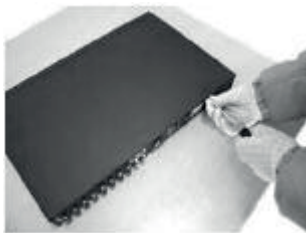
1) Открутите винты, фиксирующие крышку
