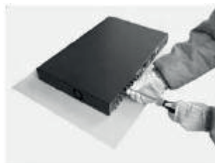
8) Зафиксируйте крышку винтами
