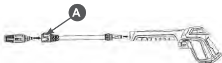
Рис. 3 Установка головки и струйной трубки
