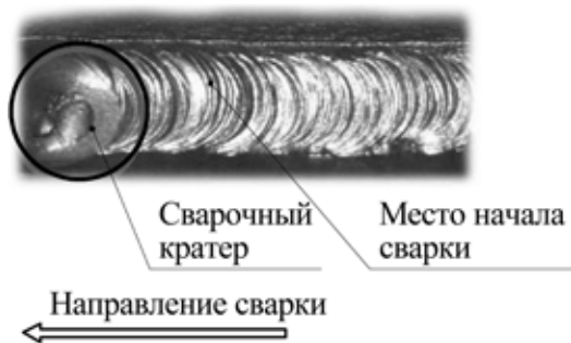
Рис. 9.4. Начало сварки при смене электрода.
