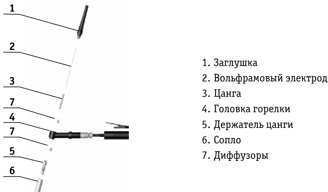
Рисунок 7.2.1 Основные компоненты горелки TIG
