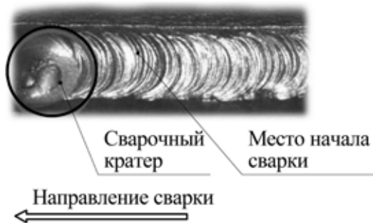
Рис. 9.4. Начало сварки при смене электрода.
