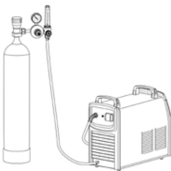
Рисунок 8.5. Подключение защитного газа.
