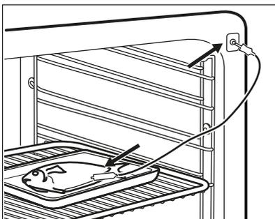
На дисплее замигает значок датчика термощупа
