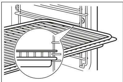
**i** Небольшой выступ наверху повышает безопасность. Выступы также служат защитой от опрокидывания. Высокий ободок по периметру решетки служит для предотвращения соскальзывания посуды с решетки.
