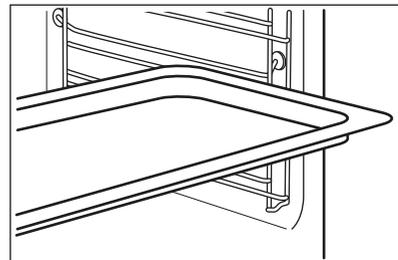
Одновременная установка решетки и эмалированного противня /сотейника:
