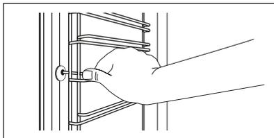
2. Вытяните заднюю часть направляющей из боковой стенки и снимите ее.
