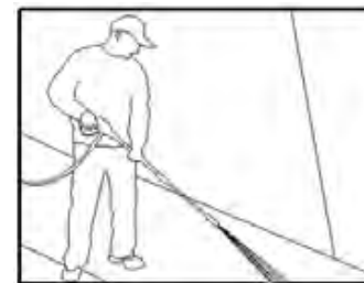
Рис. 6. Оптимальный угол относительно очищаемой поверхности
