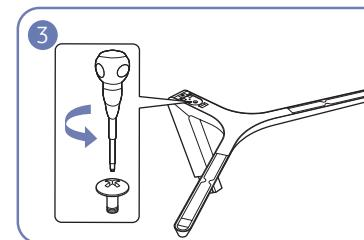
Открутите соединительный винт в нижней части подставки.
