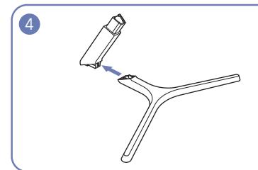
Извлеките соединительный элемент из подставки, потянув его в направлении стрелки, как показано на рисунке.
