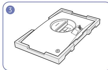
Положите на пол защитный пенопластовый материал (стирофон), входящий в комплект, и разместите на нем устройство экраном вниз, как показано на рисунке. При отсутствии защитного материала используйте толстый коврик.
