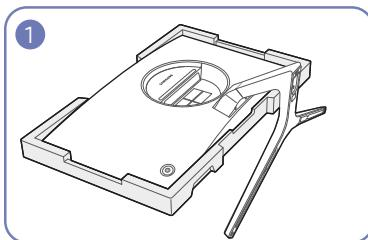
Положите на пол защитный пенопластовый материал (стирофон), входящий в комплект, и разместите на нем устройство экраном вниз, как показано на рисунке. При отсутствии защитного материала используйте толстый коврик.
