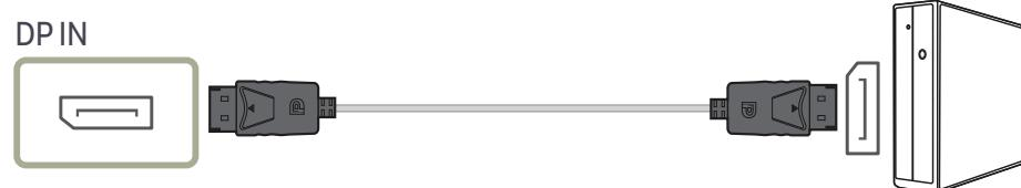
— Рекомендуется использовать кабель DP длиной до 1,5 м. Использование более длинного кабеля может повлиять на качество изображения.
