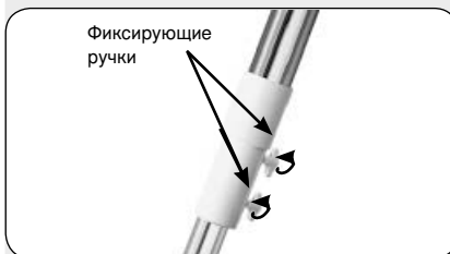
Рис. 11: Отрегулируйте высоту штатива при помощи фиксирующих ручек
