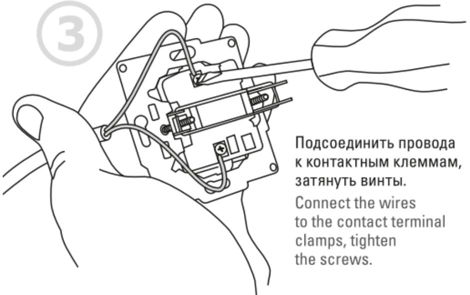
Подсоединить провода к контактным клеммам, затянуть винты.
