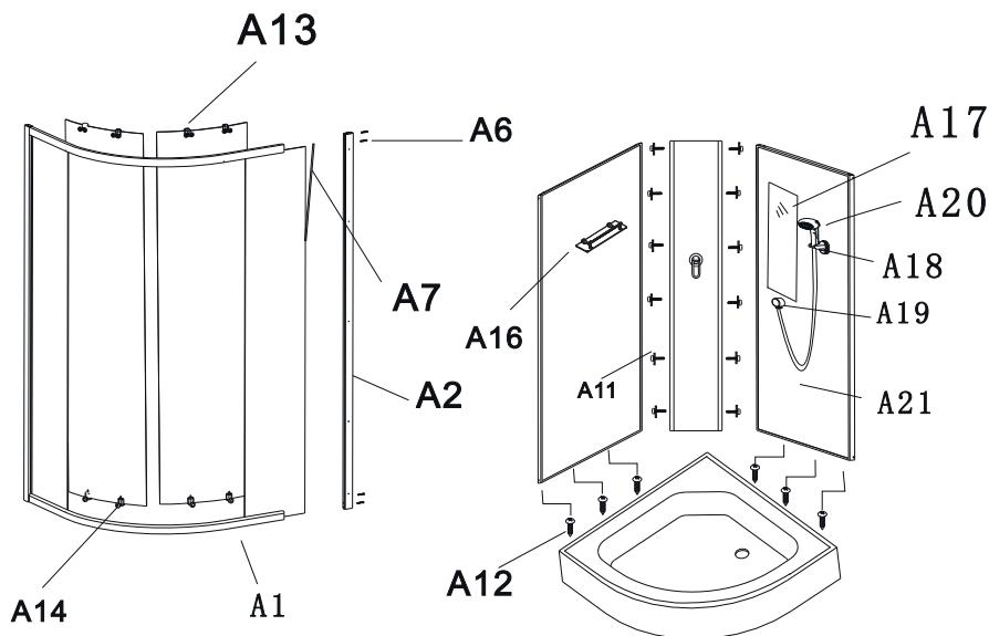
При монтаже стекол кабины, будьте внимательны! Не ставьте стекла на кафельный пол без защитного картона, избегайте ударов и падения стекол на угол!
