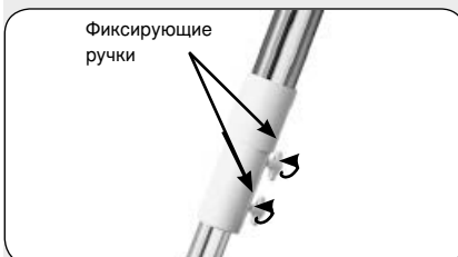
Рис. 11: Отрегулируйте высоту штатива при помощи фиксирующих ручек.
