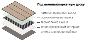
Рис. Схема монтажа теплого пола CALEO под ламинат или паркетную доску
