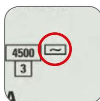
**Тип AC** – реагирует на синусоидальный переменный ток утечки, обозначается значком в виде синусоиды.
