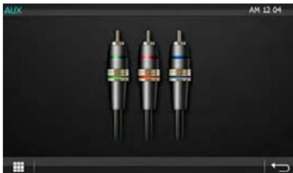
Подключите внешний источник **ВИДЕО** сигнала к разъему на задней панели – **AV IN (режим AV In)**. Для просмотра сигнала с внешнего источника нажимайте кнопку **MODE** на пульте ДУ (5), пока на дисплее не появится режим **AUX**. Либо нажмите иконку «**AUX**» (12) на главном меню устройства. Сигнал звукового сопровождения необходимо подать на RCA разъемы **AUX R/L**.
