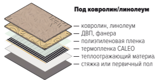
Рис. Схема монтажа теплого пола CALEO под ковролин или линолеум
