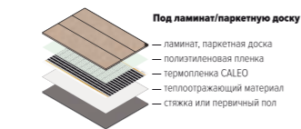
Рис. Схема монтажа теплого пола CALEO под ламинат или паркетную доску
