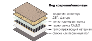
Рис. Схема монтажа теплого пола CALEO под ковролин или линолеум
