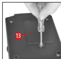
Батарейный отсек расположен в основании микроскопа (13). Ослабьте винт на крышке батарейного отсека с помощью небольшой крестовой отвертки и снимите крышку.
