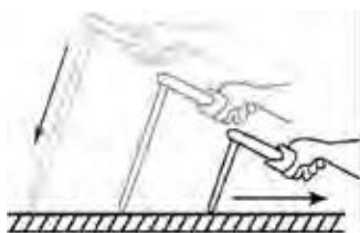
Рисунок 9. положение электрода при сварке
