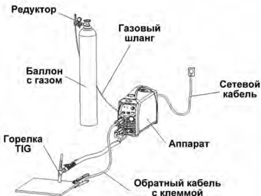
Рис. 6.2 Схема подключения оборудования для TIG сварки
