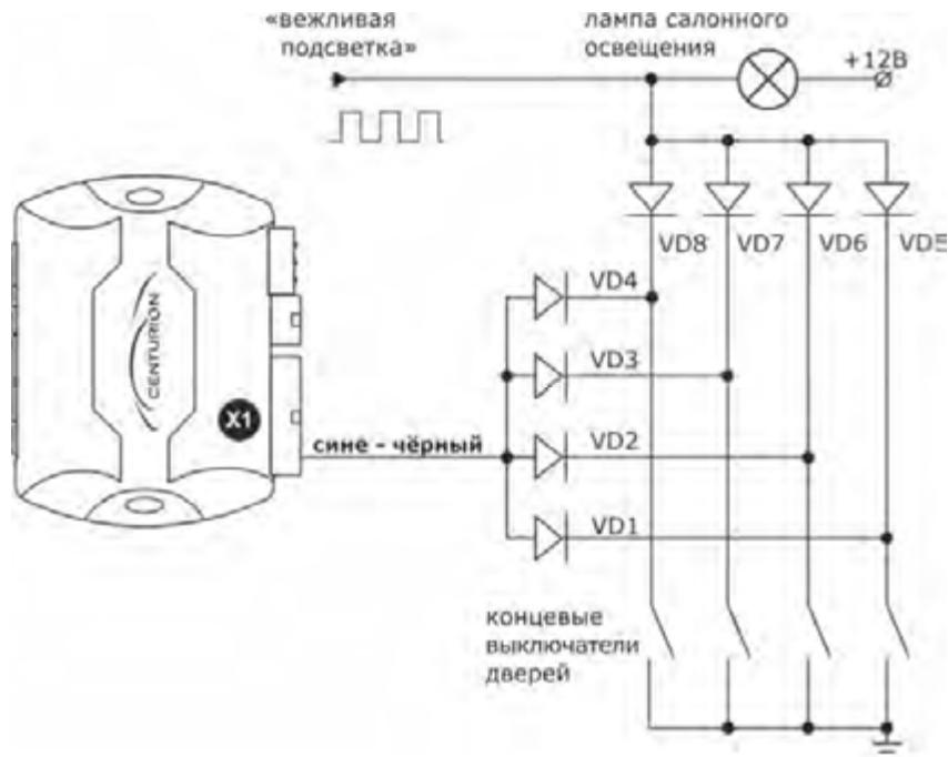
Диоды VD1–VD4 типа 1N4007. Тип диодов VD5–VD8 определяется током потребления ламп салонного освещения.
