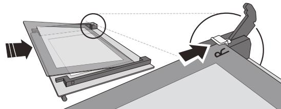
**4.** Зафиксируйте верхний край: Щелчок означает правильную установку. Перед установкой дверцы проверьте целостность уплотнения.
