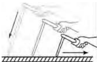
Рисунок 8. положение электрода при сварке
