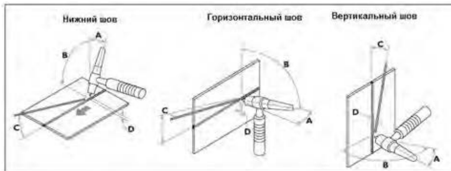
Рисунок 17. Базовые движения при работе с аргонодуговой горелкой
