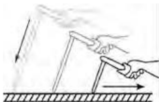
Рисунок 8. положение электрода при сварке
