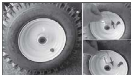
Рис.26 Установка шплинта на левом колесе
