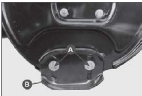
Рис.17 Регулировка высоты забора снега
