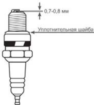
Рис. 29. Обслуживание свечи зажигания
