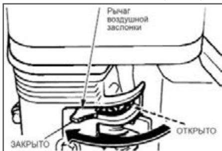
Рис.19 Установка рычага воздушной заслонки
