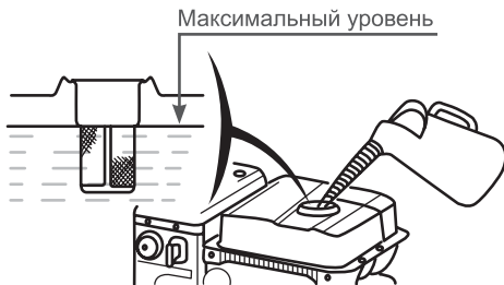
Рис.14 Максимальный уровень топлива в баке
