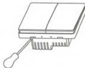
2. Используйте отвертку с прямым наконечником, чтобы открыть верхнюю панель выключателя.
