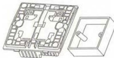
3. Прочно прикрутите настенный выключатель к клеммной коробке, используя винты.
