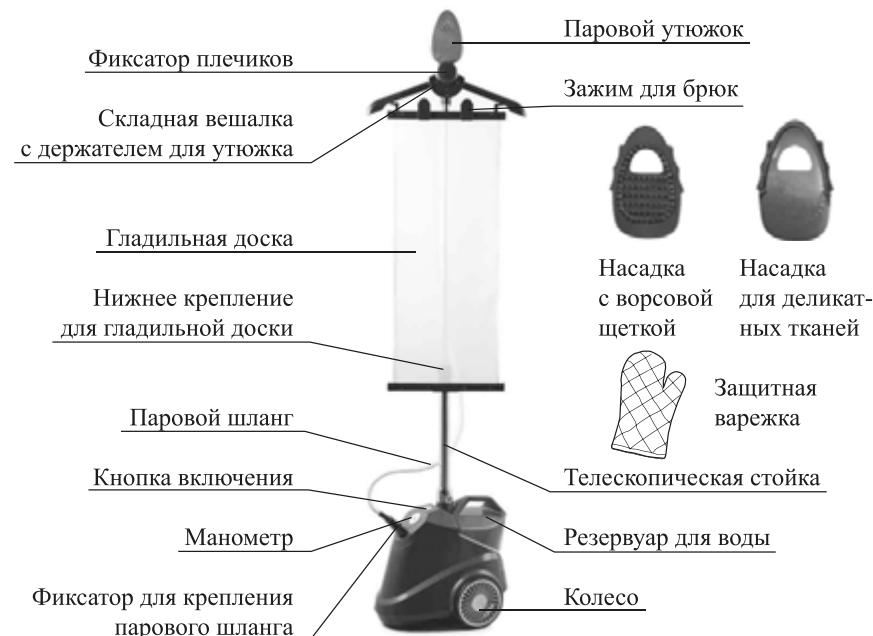
Отпариватель оснащен манометром. Съемный резервуар для воды позволяет легко залить воду. В комплекте идет телескопическая стойка, складная вешалка с держателем для утюжка и необходимые для отпаривания насадки и аксессуары.
