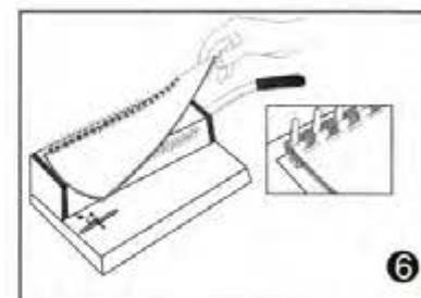
Снимите готовую брошюру с переpleтного механизма.
