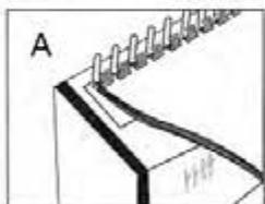
Поместите пластиковую пружину за держатель переpleтного механизма зубцами вверх.
