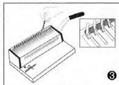
Поместите пластиковую пружину за держатель переpleтного механизма зубцами вверх.
