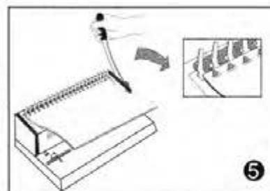
Вставляйте листы вертикально в открытую пластиковую пружину. Верните ручку зажима пружины в вертикальное положение.
