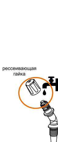
Проверяйте чистоту фильтра брандспойта и рассеивающей гайки
