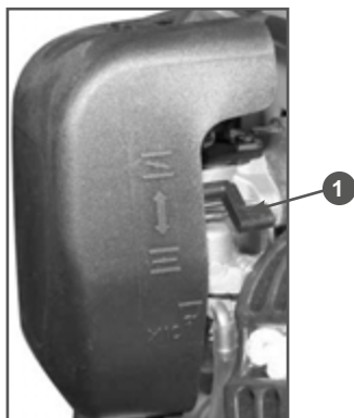
Рис. 9 Расположение воздушной заслонки
