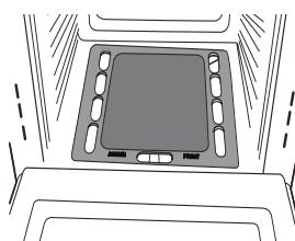
Для установки крышки горелки достаточно разместить ее на дне камеры духовки.
