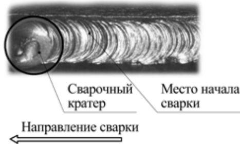
Рис. 10.4. Начало сварки при смене электрода.
