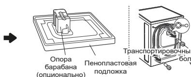
Снимите транспортировочные болты и опоры.
