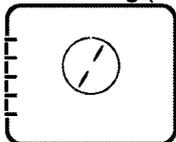
Горячий воздух, нагретый нагревательным элементом с вентилятором, быстро и равномерно распределяется в духовом шкафу с помощью вентилятора.
