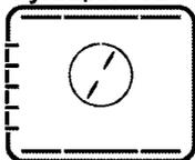
Работают верхний и нижний нагревательные элементы, а также нагревательный элемент с вентилятором. Продукты готовятся быстро и равномерно со всех сторон. Готовьте только с одним противнем.
