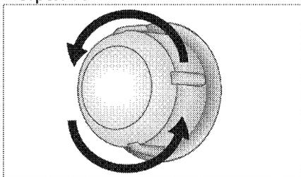
3. Если в вашей духовке используется лампа типа (А), показанная на рисунке ниже, поверните ее в соответствии с рисунком, чтобы извлечь ее и заменить. Если используется лампа типа (В), потяните и извлеките ее, как показано на рисунке, и замените.
