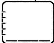
Работает только нижний нагревательный элемент. Подходит для выпечки пиццы и дополнительного обжаривания продуктов с нижней стороны.
