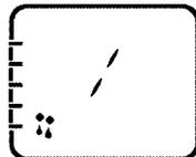
Духовой шкаф не нагревается. Работает только вентилятор, расположенный на задней стенке. Замороженные гранулированные продукты медленно размораживаются при комнатной температуре, а приготовленные продукты охлаждаются.
