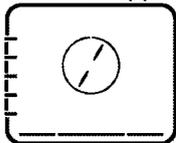
Работают нижний нагревательные элементы и нагревательный элемент с вентилятором. Подходит для приготовления пиццы.
