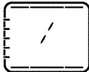
Горячий воздух, нагретый нижним и верхним нагревательным элементом, быстро и равномерно распределяется в духовом шкафу с помощью вентилятора. Готовьте с одним противнем.
