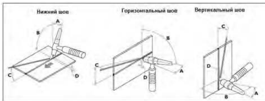
Рисунок 18. Базовые движения при работе с аргонодуговой горелкой
