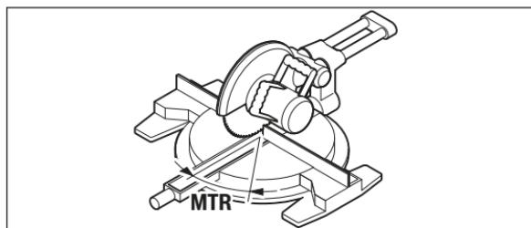
Apăsați tasta „MTR“ **8**. Atât timp cât veți apăsață tasta „MTR“ **8**, va fi afișat unghiul calculat de înclinare în plan orizontal „MTR“, care trebuie reglat la ferăstrăul circular stăționar. Concomitent, pe display luminează indicatorul „MTR“.
