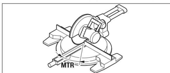
Pritisnite ponovo taster **7**. Na displeju se pojavljuje „**MTR**“ i izračunati horizontalni ugao iskošenja za testeru za presecanje i iskošenje.
