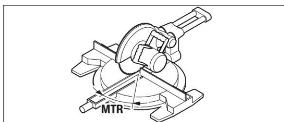
Nyomja meg ismét a **7** gombot. A kijelzőn megjelenik az „**MTR**” és a számított vízszintes sarkalószög a rövidítő és sarkaló fűrész számára.
