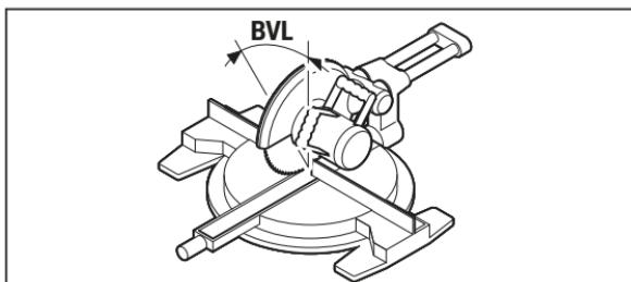
Stiskněte znova tlačítko **7**. Na displeji se objeví „**BVL**“ a vypočítaný vertikální úhel sklonu pro kapovací a pokosovou pilu.
