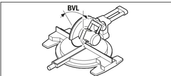
Nyomja meg ismét a **7** gombot. A kijelzőn megjelenik a „**BVL**” és a számított függőleges sarkalószög a rövidítő és sarkaló fűrész számára.
