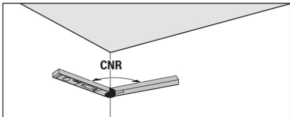
Postavite preklopni i osnovni krak za mjerjenje kuta ravno uza zidove ili podesite poznati kut na mjernom alatu.
