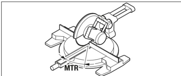
Притиснете го копчето „MTR“ 8. Сè додека го држите притиснатото копчето „MTR“ 8, ќе се прикажува пресметаниот хоризонтален агол на закосување „MTR“, кој мора да се постави на пилата за отсекување и сечење под агол. Истовремено светнува индикаторот „MTR“ на екранот.
