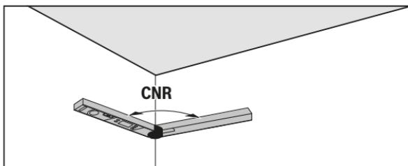
A sarokszög méréséhez helyezze fel a kihajtható és az alapszárát síkban a falakra, vagy állítson be a mérőműszeren egy ismert sarokszöget.
