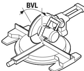
Ponovo pritisnite tipku **7**. Na displeju će se pojaviti »**BVL**« i izračunat vertikalni kut kosog rezanja za pilu za odrezivanje i koso rezanje.
