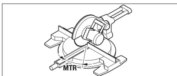
Stiskněte znova tlačítko **7**. Na displeji se objeví „**MTR**“ a vypočítaný horizontální úhel pokusu pro kapovací a pokosovou pilu.
