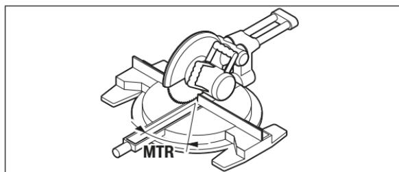
Вновь нажмите кнопку **7**. На дисплее отображается «**MTR**» и рассчитанный горизонтальный угол распила для торцовочно-усорезной пилы. По горизонтальному углу скоса задается поворот стола (**MTR**).
