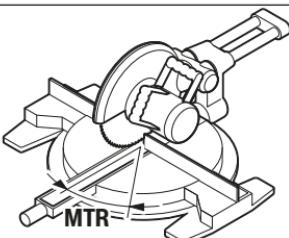
Одново притиснете го копчето **7**. На еcranот се појавуваат „**MTR**“ и пресметаниот хоризонтален агол на закосување за пилата за отсекување и сечење под агол.
