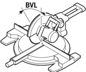
Pritisnite ponovo taster **7**. Na displeju se pojavljuje „**BVL**“ i izračunati vertikalni ugao iskošenja za testeru za presecanje i iskošenje.
