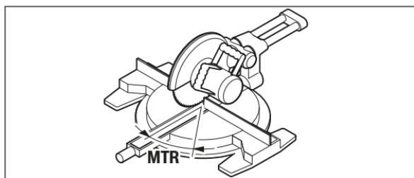
Ponovno pritisnite tipku **7**. Na displeju će se pojaviti »**MTR**« i izračunat horizontalni kut kosog rezanja za pilu za odrezivanje i koso rezanje.
