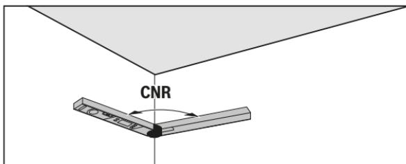
Aby pomierzyć narożnik należy ramię stałe i ramię odchylane przyłożyć płasko do ścian lub ustawić na urządzeniu pomiarowym znany kąt.
