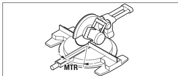
Знову натисніть кнопку **7**. На дисплеї висвічується «**MTR**» і вираховане значення горизонтального кута розпилювання для торцювально-високої пилки.
