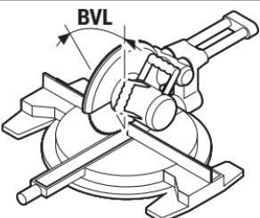
Вновь нажмите кнопку **7**. На дисплее отображается «**BVL**» и рассчитанный вертикальный угол распила для торцовочно-усорезной пилы.
