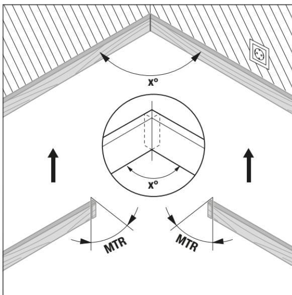
Vypočíta sa horizontálny uhol zošikmenia „**MTR**“ („Miter Angle“: horizontálny uhol zošikmenia), o ktorý musia byť oba obrobky skrátené. Pílový list sa pri týchto šikmých rezoch nachádza k obrobku v zvislej polohe (vertikálny uhol zošikmenia má hodnotu  $0^\circ$ ).
