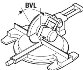
Apăsați din nou tasta **7**. Pe display apar „**BVL**“ și unghiul de înclinare în plan vertical calculat pentru ferăstrăul circular stătiorar.
