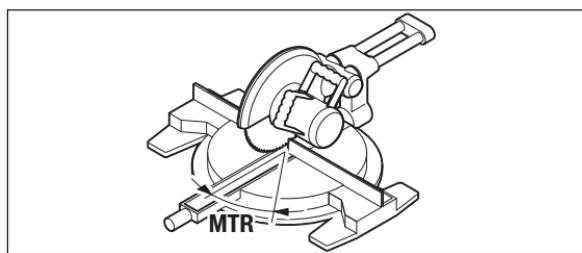
Apăsați din nou tasta **7**. Pe display apar „**MTR**“ și unghiul de înclinare în plan orizontal calculat pentru ferăstrăul circular statcionar.
