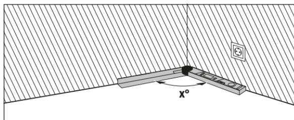
Ako radni komadi treba da se stave napasuju u ugao (na primer za letve za podove), onda izmerite ugao čoška **x°** naleganjem preklopljenog i baznog kraka. Za zadate uglove (na primer okvire za slike) otvorite preklopljene i bazne krakove toliko, sve dok se na prikaze na displeju željeni ugao.
