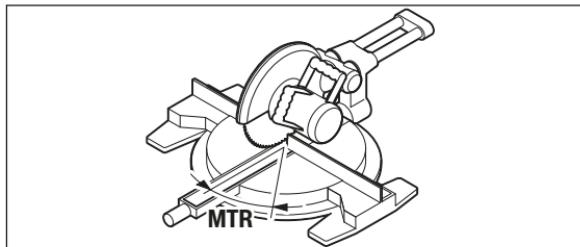
Нажмите на кнопку «**MTR**» 8. До тех пор, пока Вы нажимаете на кнопку «**MTR**» 8, будет отображаться рассчитанный горизонтальный угол скоса «**MTR**», который нужно настроить на торцовочно-усорезной пиле. Одновременно на дисплее загорается индикатор «**MTR**».
