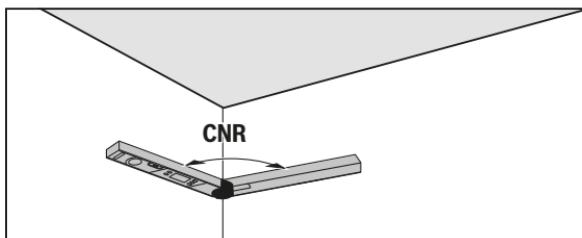
Așezați rigla mobilă și cea fixă pentru măsurarea unghiului de colț orizontal pe perete sau reglați un unghi de colț cunoscut la aparatul de măsură.
