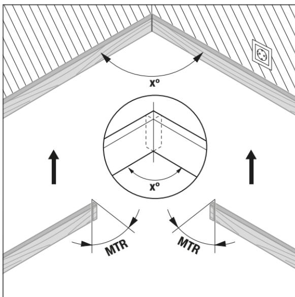
Vypočítán bude horizontální úhel pokusu „**MTR**“ („Miter Angle“: horizontální úhel pokusu), o který musejí být zkráceny oba obrobky. Pilový kotouč stojí u tétoho pokosových řezů kolmo vůči obrobku (vertikální úhel sklonu činí  $0^\circ$ ).
