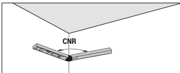
Sklopivi i osnovni krak za merenje ugla čoška položite ravno na zid ili podešite poznati ugao čoška na mernom alatu.
