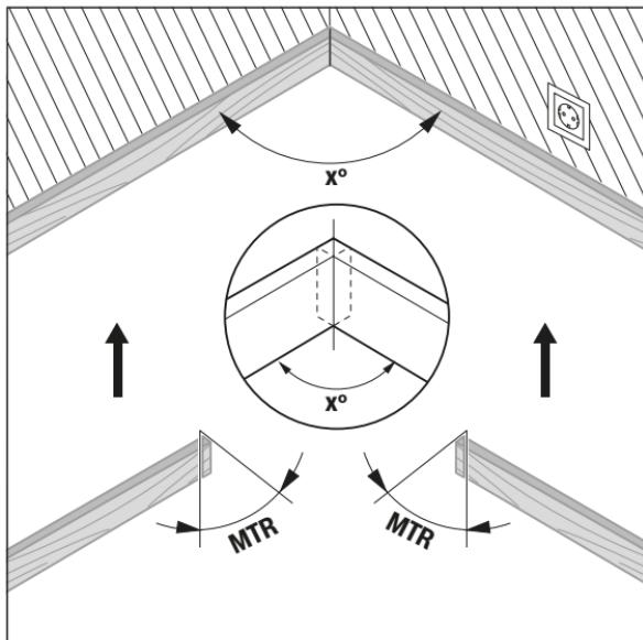
Se calculează unghiul de înclinare în plan orizontal „**MTR**“ („Miter Angle“: unghi de înclinare în plan orizontal), în care se vor tăia cele două piese de lucru. La aceste tăieri oblice până de ferăstrău este perpendiculară pe piesa de lucru (unghiul de înclinare în plan vertical este de  $0^\circ$ ).
