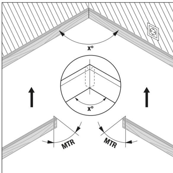
Lai abus priekšmetus varētu savienot vēlamajā leņķi, jāaprēķina horizontālais slīpuma leņķis „MTR“ („Miter Angle“: horizontālais slīpuma leņķis), ar kuru jaapzāgē abi savienojamie priekšmeti. Šajā gadījumā zāga asmenim jāatrodas stateniski attiecībā pret zāģējamo priekšmetu (vertikālajam zāģēšanas leņķim jābūt  $0^\circ$ ).
