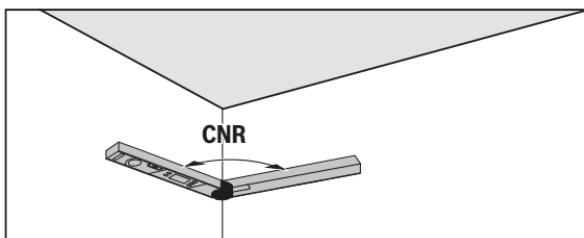
Přiložte sklopné a základní rameno pro změření úhlu rohu plošně ke stěnám a nastavte na měřicím přístroji známý úhel rohu.
