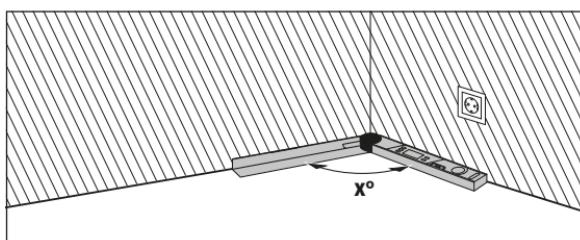
Ha a munkadarabokat egy sarokba kell beilleszteni (például padlólécekhez), akkor a kihajtható és az alapszár felhelyezésével mérje meg a **x°** sarokszöget. Egy adott szögértékhöz (például képeret) nyissa szét annyira a kihajtható és az alapszárat, hogy a kívánt szögérték kerüljön kijelzésre.
