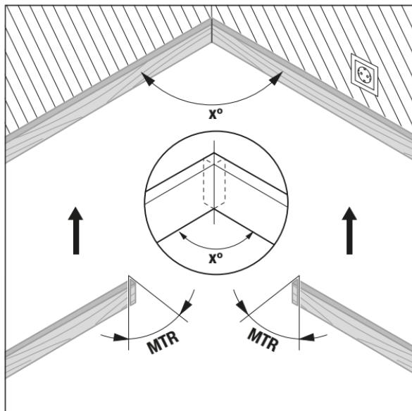
Визначається горизонтальний кут розпилювання «MTR» («Miter Angle»: горизонтальний кут розпилювання), на який повинні бути підрізані заготовки. При цих кутах розпилювання пиллярний диск знаходиться перпендикулярно до заготовки (вертикальний кут розпилювання складає  $0^\circ$ ).
