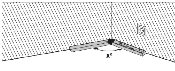
Če želite obdelovance prilagoditi v kot (npr. talne letvice), potem izmerite vogalne kote **x°** s prileganjem zložljivega in osnovnega traka. Za vnaprej podane kote (npr. okvir) odprite zložljiv in osnovni krak tako daleč, da se željen kot prikaže na displeju.
