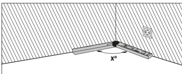
Mají-li být obrobky vsazeny do rohu (např. pro podlahové lišty), pak změřte úhel rohu  $x^\circ$  přiložením sklopného ramene a ramene základny. Pro zadání úhly (např. rámy obrazů) rozevrťte sklopné rameno a rameno základny na tolik, až se na displeji zobrazí požadovaný úhel.
