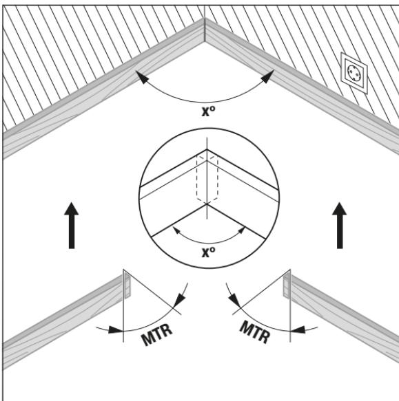
Obliczany jest poziomy kąt cięcia »MTR« (»Miter Angle«: poziomy kąt cięcia), o który obrabiane elementy muszą zostać skrócone. Brzeszczot należy przy tego typu cięciach ustawać pionowo do obrabianego materiału (pionowy kąt cięcia ma wynosić  $0^\circ$ ).
