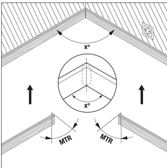
Ekkor kiszámításra kerül az „**MTR**” („Miter Angle” vízszintes sarkalószög), amennyivel le kell rövidíteni a két munkadarabot. Ennél a sarokvágásnál a fűrészlap a munkadarabra merőlegesen áll (a függőleges sarkalószög  $0^\circ$ ).
