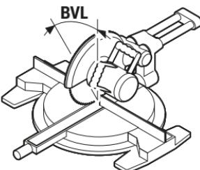
Знову натисніть кнопку **7**. На дисплей висвічується «**BVL**» і вирахуване значення вертикального кута розпилювання для торцюально-вусорізної пилки.
