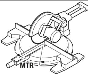
Pritisnite tipko „**MTR**“ **8**. Dokler držite pritisnjeno tipko „**MTR**“ **8**, bo prikazan izračunan vodoraven kot zajere „**MTR**“, ki ga je treba nastaviti na čelilni in zajeralni žagi. Istočasno sveti indikator „**MTR**“ na prikazovalniku.
