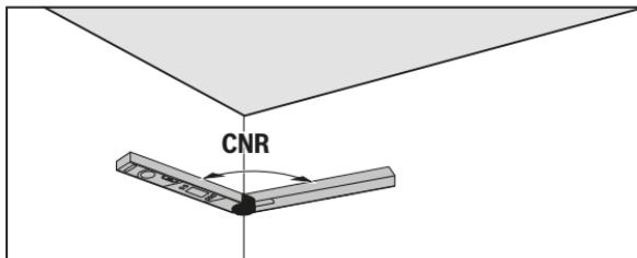
Для измерения угла между стенами приложите складное и основное плечо плоско к стене или настройте известный угол между стенами на измерительном инструменте.
