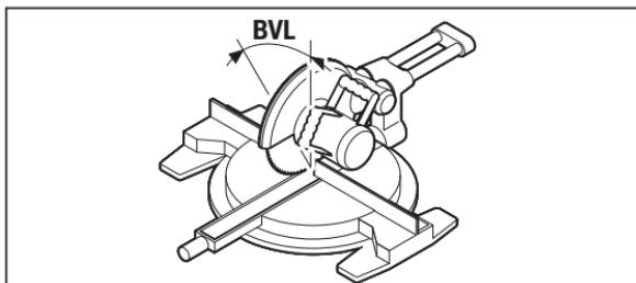
Stlačte znova tlačidlo **7**. Na displeji sa zobrazí „**BVL**“ a vypočítaný vertikálny uhol zošikmenia pre kapovaciú a pokosovú pílu.
