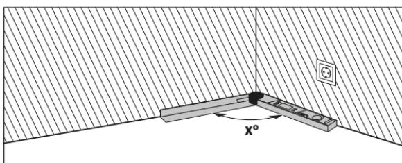
Ak majú byť dva obrobky zapasované do kúta (napríklad podlahové lišty), potom odmerajte rohový uhol **x°** priložením sklopacieho a základného ramena. Pre vopred stanovené uhly (napríklad rámy obrazov) otvorte sklopacie a základné rameno načoľko, aby sa na displeji zobrazil požadovaný uhol.
