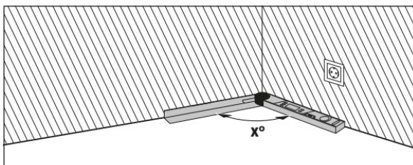
Ako se izraci trebaju pripasati u ugлу (npr. za podne letvice), u tom slučaju izmjerite kut u ugлу **x°** polaganjem preklopnog i osnovnog kraka. Za pretvodno zadani kut (npr. okvir za sliku) otvorite preklopni i osnovni krak toličko dok se na displeju ne pokaže traženi kut.
