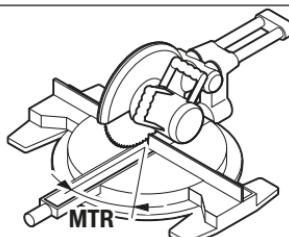
Натиснете бутона „MTR“ 8. Докато държите натиснат бутона „MTR“ 8, се изобразява изчисленияят хоризонтален ъгъл на скосяване „MTR“, който трябва да бъде настроен на циркулярната машина. Същевременно на дисплея светва индикаторът „MTR“.
