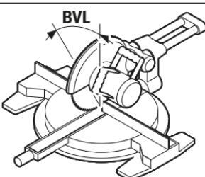
Одново притиснете го копчето **7**. На еcranот се појавуваат „**BVL**“ и пресметаните вертикални агли на закосување за пилата за отсекување и сечење под агол.
