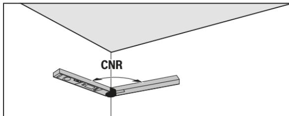
Для вимірювання кутового кута покладіть складне і базове плече всію поверхнію до стіни або налаштуйте відомий кутовий кут на вимірювальному інструменті.
