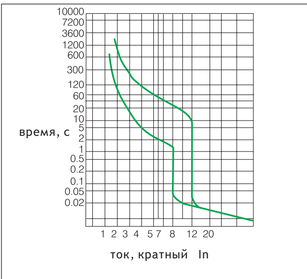
Характеристики выключателей NM1 -630, NM1 -800
