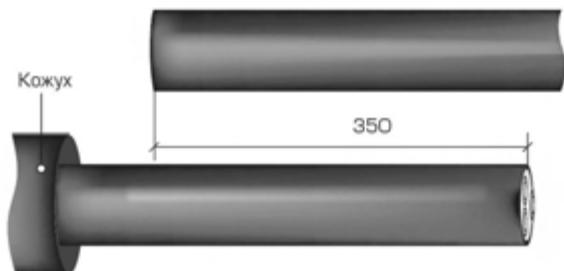
**1.1** Распрямить один конец кабеля на длине 2000 мм, другой — 1500 мм, очистить их от загрязнений и расположить их друг напротив друга с перехлестом в 350 мм.
