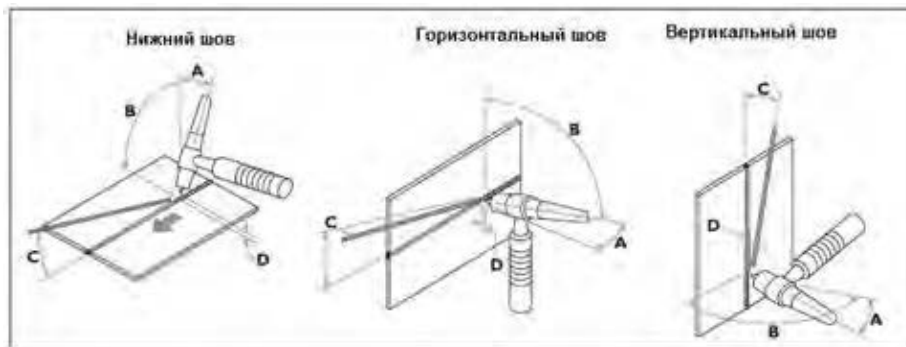
Рисунок 18. Базовые движения при работе с аргодуговой горелкой
