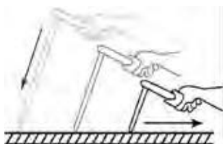
Рисунок 9. положение электрода при сварке
