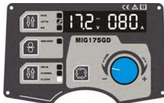
Рис 7: Дисплей после сварки в режиме TIG
