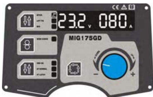
Рис 4: Дисплей в режиме STICK.
