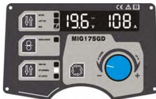
Рис 13: Дисплей после окончания сварки MIG
