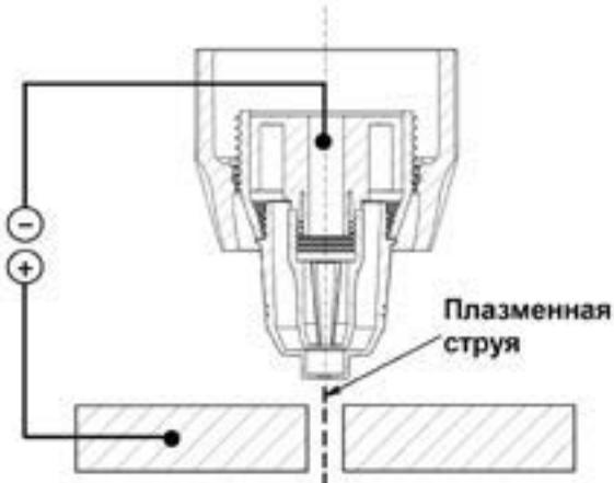
Рис. 7.3. Процесс плазмообразования.
