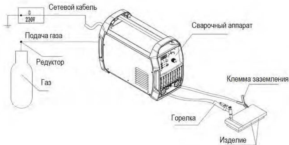
Рисунок 20. Схематичное подключение при сварке TIG
