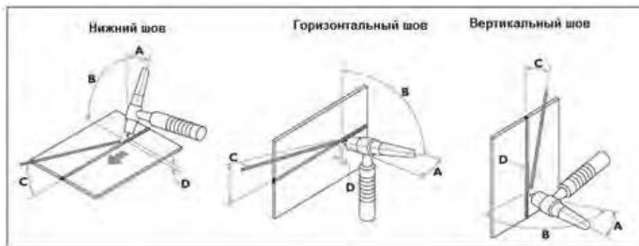
Рисунок 24. Базовые движения при работе с аргодуговой горелкой
