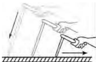
Рисунок 14. положение электрода при сварке
