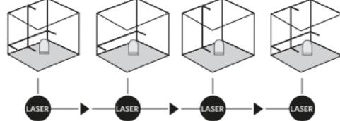
! Do niwelacji poziomej i pionowej zabezpieczenie transportowe musi być zwolnione. Dioda LED świeci stałym zielonym światłem. Gdy urządzenie znajduje się poza automatycznym zakresem niwelacji wynoszącym 5°, linie laserowe migają, a dioda LED świeci na czerwono. Ustawić urządzenie tak, aby znalazło się w zakresie niwelacji. Dioda LED ponownie świeci na zielono, a linie laserowe świecą stałe.
