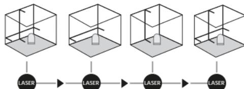
! Horizontal og vertikal nivellering krever at transportsikringen løsnes. LED-en lyser konstant grønt. Straks apparatet befinner seg utenfor det automatiske nivelleringssområdet på 5°, blinker laserlinjene og LED-en lyser rødt. Posisjoner apparatet slik at det befinner seg innenfor nivelleringssområdet. LED-en lyser grønt igjen og laserlinjene lyser konstant.
