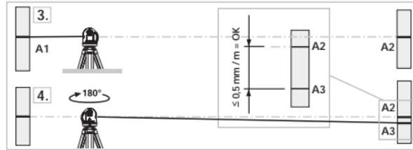
! Dacă A2 și A3 se află la o distanță mai mare de 0,5 mm / m, trebuie efectuată o calibrare. Contactați un comerciant specializat și adresați-vă departamentului service UMAREX-LASERLINER.
