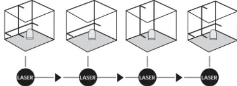
! Pro horizontální a vertikální nivelační musí být uvolněná transportní pojistka. LED svítí nepřerušovaně zeleně. Jakmile se přístroj nachází mimo rozsah automatické nivelače 5°, blikají laserové linie a LED se rozsvítí červeně. Umístěte přístroj tak, aby se nacházel uvnitř rozsahu nivelače. LED se opět rozsvítí zeleně a laserové linie svítí nepřerušovaně.
