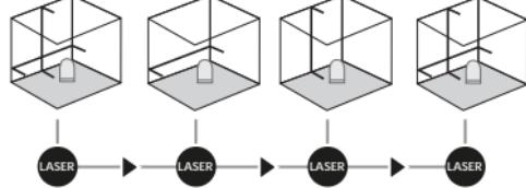
! Lai veiktu horizontālo un vertikālo līmeņošanu, jābūt atbrīvotam transporta drošinātājam. Pastāvīgi deg zaļa gaismas diode. Tīklīdz ierīce novirzās no automātiskās 5° līmeņošana zonas, sāk mirgot lāzera stari un iedegas sarkana gaismas diode. Novietojiet ierīci tā, lai tā atrastos līmeņošanas zonā. No jauna iedegas zaļa gaismas diode un lāzera stari deg pastāvīgi.
