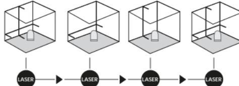
! Voor de horizontale en verticale nivelleren moet de transportbeveiling gedactiveerd zijn. De led brandt constant groen. Zodra het apparaat zich buiten het automatische nivelleerbereik van 5° bevindt, knipperen de laserlijnen en brandt de led rood. Positioneer het apparaat zodanig dat het zich binnen het nivelleerbereik bevindt. De led schakelt weer over naar groen en de laserlijnen branden constant.
