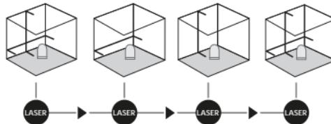
! Для горизонтального і вертикального нівелювання необхідно розфіксувати транспортне стопоріння. Постійно світиться зелений світлодіод. У разі виходу за межі діапазону автоматичного нівелювання, що становить 5°, лазерні лінії починають блимяти, а світлодіодний індикатор загоряється червоним світлом. Розташуйте прилад так, щоб він потрапив у межі діапазону автоматичного нівелювання. Світлодіод знову змінить колір на зелений, а лазерні лінії загоряться сталим світлом.
