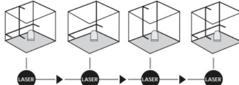
! Yatay ve düşey düzeyeleme için taşıma emniyetinin çözülmüş olması gerekmektedir. LED sabit şekilde yeşil yanar. Cihaz otomatik düzeyeleme aralığı olan 5°'nin dışında bulunduğu zaman, lazer çizgileri yanıp sönmeye başlarlar ve LED kırmızı yanar. Cihazı düzeyeleme aralığı içinde bulunacak şekilde konumlandırınız. LED yine yeşile döner ve lazer çizgileri sabit yanarlar.
