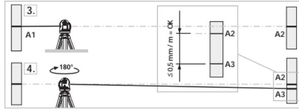
! Se os pontos A2 e A3 estiverem separados mais de 0,5 mm / m é necessário efectuar uma calibragem. Contacte o seu distribuidor ou dirija-se ao departamento de assistência da UMAREX-LASERLINER.
