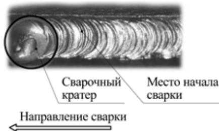
Рис. 9.4. Начало сварки при смене электрода.
