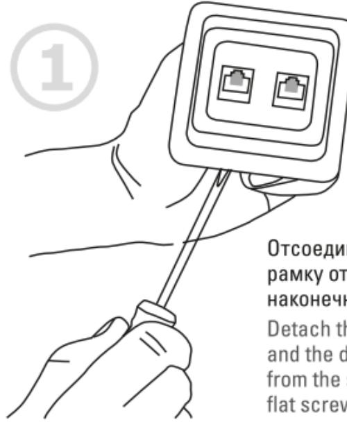
Отсоединить крышку и деко-ративную рамку от корпуса розетки, поддев наконечником плоской отвертки.
