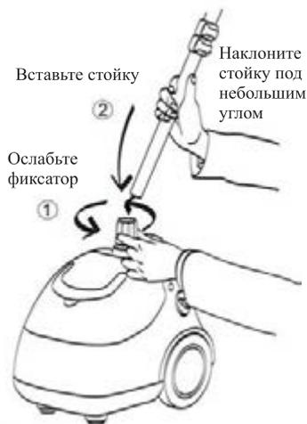
2. Откройте замочки на стойке. Для того чтобы выдвинуть стойку одной рукой удерживайте нижнюю часть стойки, а верхнюю часть вытаскивайте на нужную высоту и зафиксируйте замочком.
