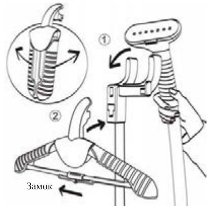
6. Установите вешалку в соответствующие пазы на крючке. Расправьте плечи вешалки и зафиксируйте их замком.
