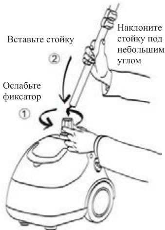
2. Откройте замочки на стойке. Для того чтобы выдвинуть стойку одной рукой удерживайте нижнюю часть стойки, а верхнюю часть вытаскивайте на нужную высоту и зафиксируйте замочком.
