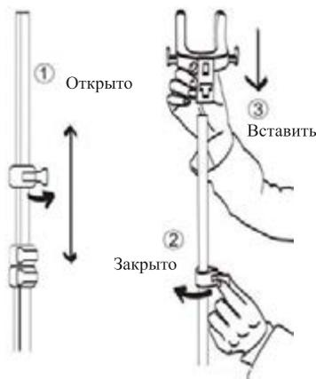
4. Подсоедините паровой шланг. Для этого установите коннектор в корпус отпаривателя и закрутите гайку по часовой стрелке до упора.
