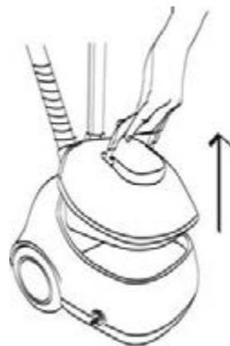
2. Переверните резервуар и откройте крышку резервуара против часовой стрелки.
