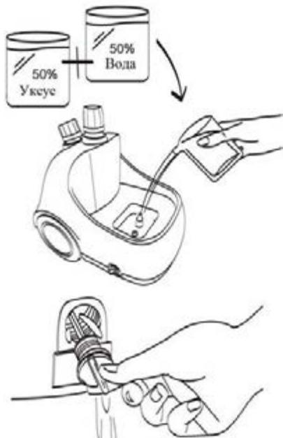
7. Если вам неудобно каждый раз переворачивать отпариватель, то вы можете слить воду из бойлера через пробку, которая находится сбоку корпуса. Пробка откручивается против часовой стрелки.
