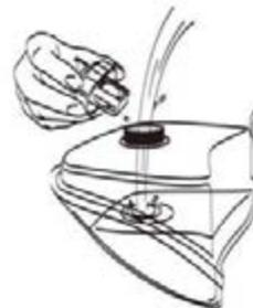
3. Налейте воду в резервуар и закрутите крышку по часовой стрелке. Установите резервуар с водой в корпус отпаривателя.
