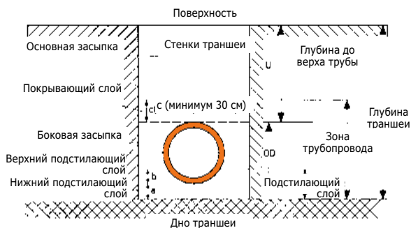
Рис. 3 Устройство траншеи
