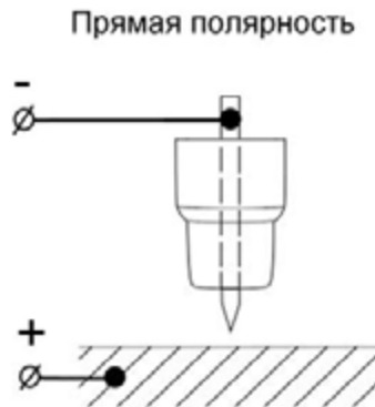
Рис. 8.4. Полярность при TIG сварке.
