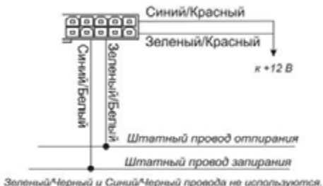
Схема 2. 3-проводная система с положительной полярностью (большинство автомобилей GM)
