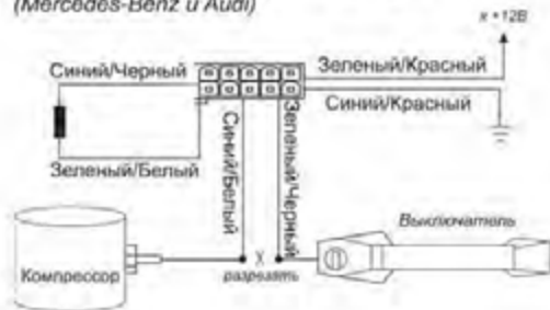
Схема 4. Вакуумная система центрального замка (Mercedes-Benz и Audi)
