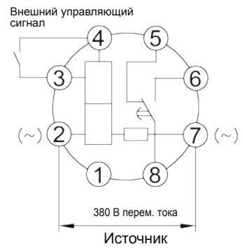
Рис. 13: Схема проводных соединений JSZ3K (380 В)
