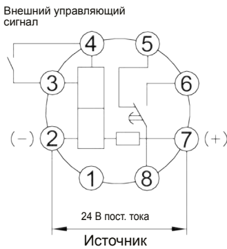
Рис. 14: Схема проводных соединений JSZ3K (24 В пост. тока)
