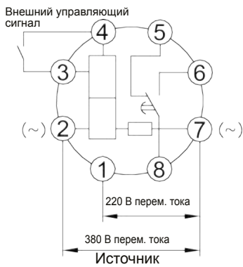
Рис. 11: Схема проводных соединений JSZ3K (380 В, 220 В)
