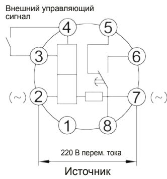
Рис. 12: Схема проводных соединений JSZ3K (220 В)
